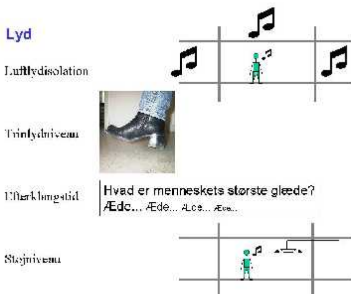
Figur 5. Billeder, der forklarer de fire parametre, der gælder lydforhold, og som reguleres i Bygningsreglementet.
