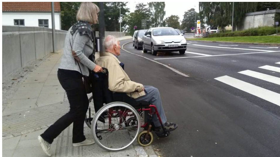
Figur 48: Lav eller ingen kant betyder reduceret stødpåvirkning
