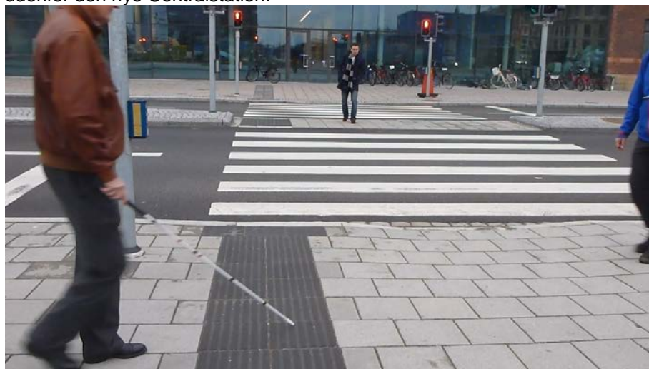
Figur 53: Finde retningsorienterende felt med sinusformet profil, Malmø
