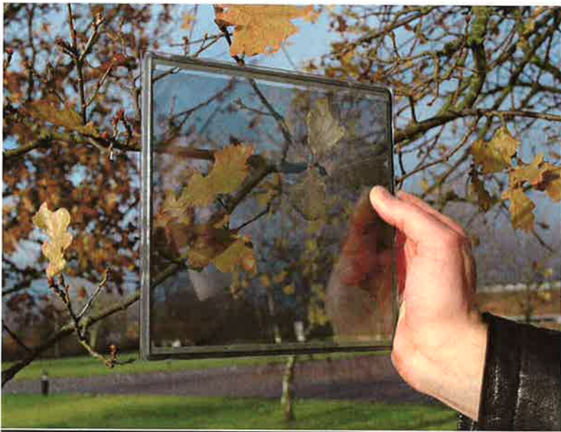
Figur 4.6: Billede som viser udsynet gennem en prototype på den vinkelselektive solcelle. Det viste element har en afskærmningsvinkel på 60 grader og en transmittans på 60 %.
