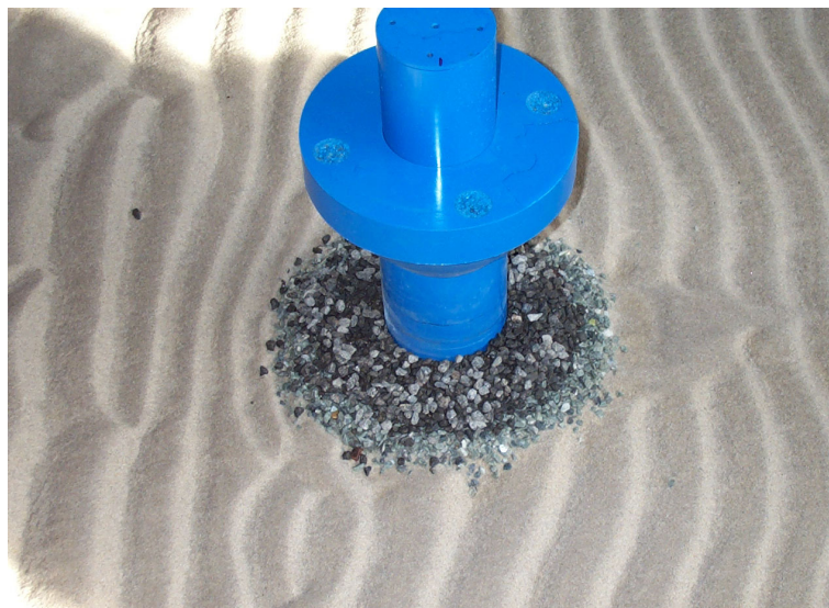
Forsøg udført ved Aalborg Universitet med bundbeskyttelse omkring vindmøllefundament.
