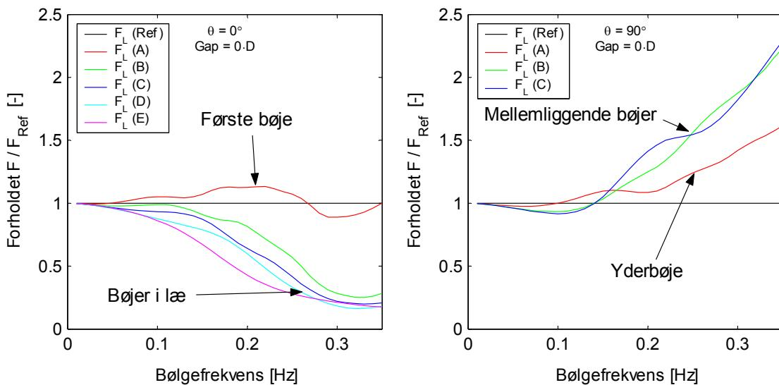
Figur 9. Eksempel på bølgekræfter for gap = 0. Bølgeretning  $\theta = 0^\circ$  (venstre) og  $\theta = 90^\circ$  (højre). Pga. symmetri er  $F_L(A) = F_L(E)$  og  $F_L(B) = F_L(D)$  for  $\theta = 90^\circ$ .
