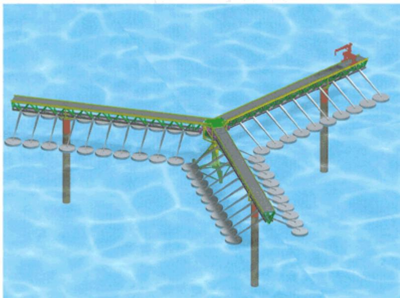
**Figur 1. Principel opbygning af Wave Star med rækker af flydere**
