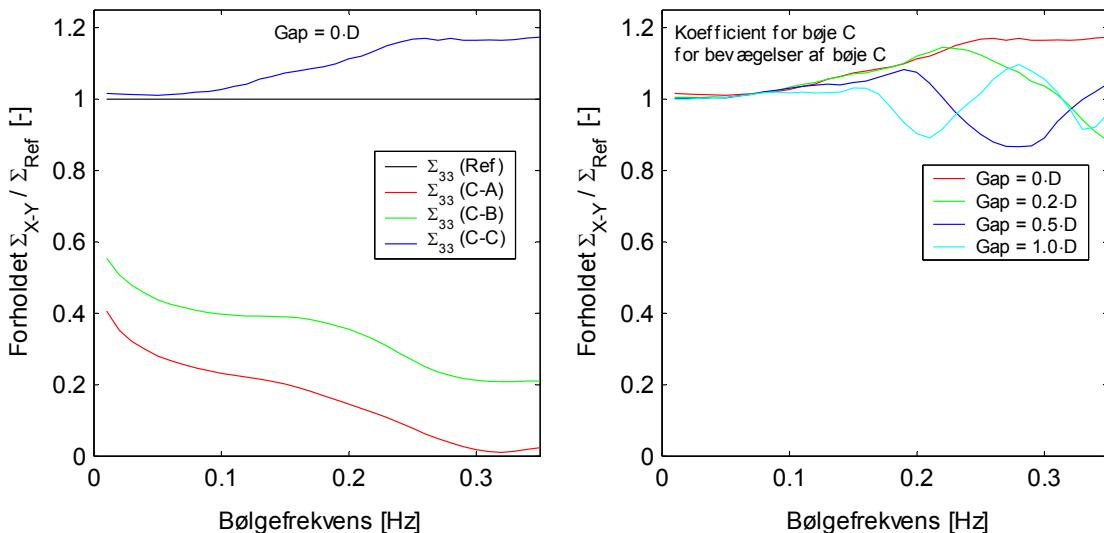
**Figur 8. Eksempel på hydrodynamiske modstandstal. Koblinger mellem koefficenter for bøje C ved gap = 0 (venstre) og koefficient C-C ved forskellige gaps (højre).**
