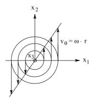
Figure 1.13: Rotational flow, rot  $\vec{v} \neq \vec{0}$ .
