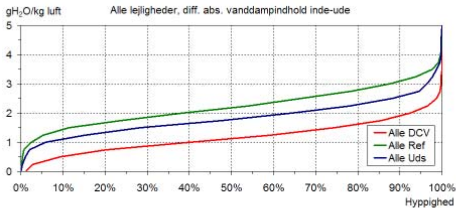
Figur 20. Figuren viser for hver af de tre grupper af lejligheder kumuleret, relativ fordeling af den gennemsnitlige differens mellem indeluftens og udeluftens absolute vanddampindhold. Kurverne viser den procentvise andel af tiden i måleperioden, hvor differensen er lavere end angivet på ordinataksen. Eksempel (grøn kurve øverst): I gennemsnit for Ref-lejlighederne er differensen mellem indeluftens og udeluftens absolute vanddampindhold i 90 procent af tiden lavere end ca. 3,1 gH 2 O/kg luft.
