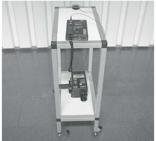
Figur 4.1. Rullebord med fotocelle og luxmeter.
