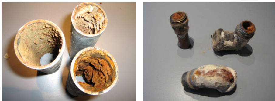
Figur 1.5.1. 40 år gamle vandrør. Tilkalkning (BK, BC,BV), tæring i bøjninger og samlinger. (Foto: Fyns almennyttige Boligselskab).
