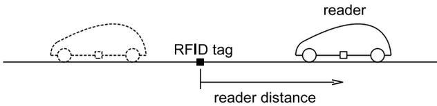
Fig. 10. RFID tag on the road scenario.
