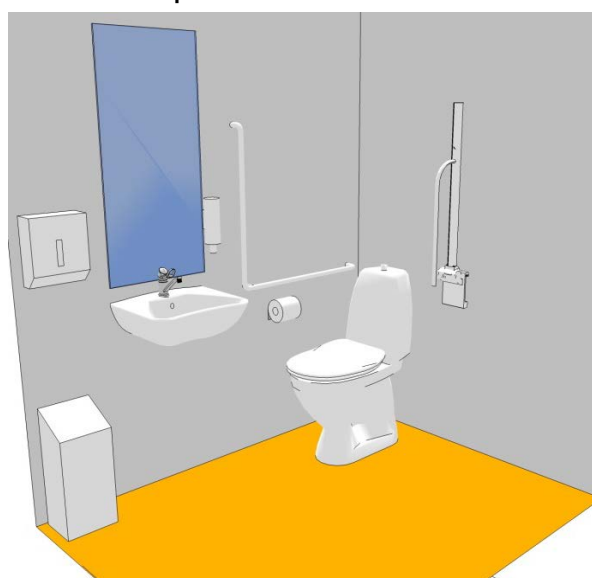
Figur 1: Eksempel på indretning efter MSC Circ. 735. Vendeplads for kørestolsbrugere bliver i dette tilfælde for lille. Ved denne model anbefales fastmonteret armstøtte som vist på figuren.
