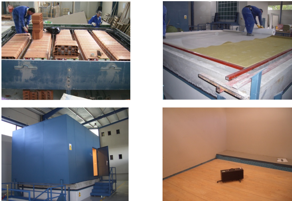
Figura 3. Ejemplo. Cámaras normalizadas de AUDIOTEC para ensayos de aislamiento acústico de cerramientos horizontales
