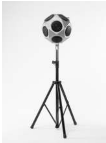
Figura 8. Fuente sonora omnidireccional situada sobre el trípode
