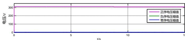
(c)带不对称负荷的非主参考微电源各相序电压幅值
