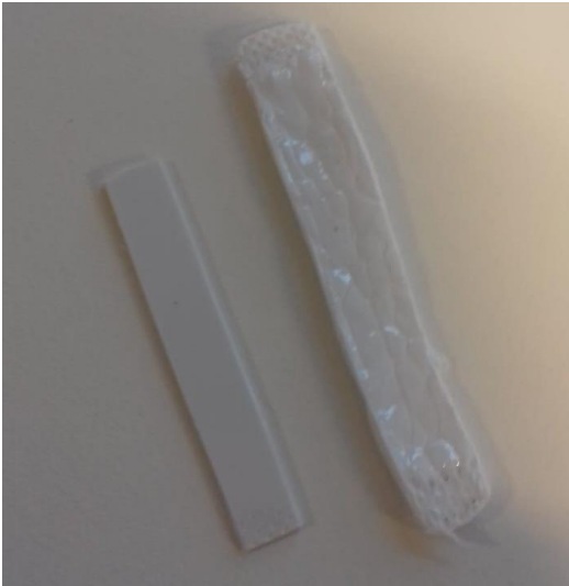
Figur 19 Lille emne er tør ABS, stor emne er kvældet ABS på dag 20, udtaget fra carbon tetrachloride opløsningen.
