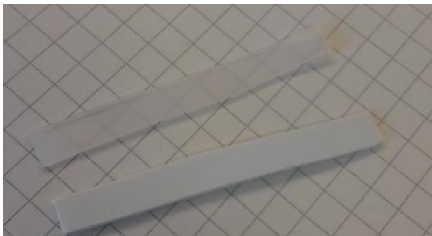
Figur 10 HDPE og ABS prøver inden de blandes med opløsningsmiddel. ABS er det hvide emne.
