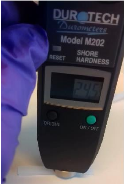
Figur 11 Hårdhedsmåleren trykket på emnet og viser en shore A måling på 24,5
