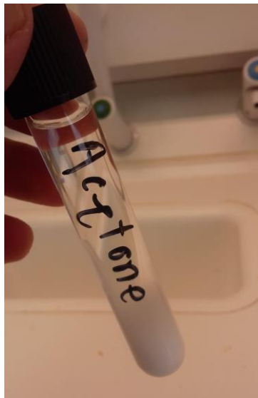
Figur 17 Acetone med opløst ABS. Billede fra dag 1, der er ikke sket yderligere til om med dag 20
