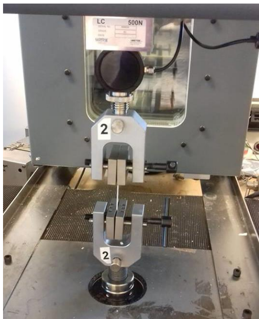
Figur 14 Trækstyrkeapparat med 500 N vejecelle og små kæber og emnet spændt fast mellem kæberne.
