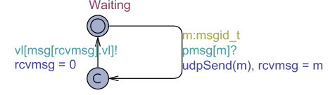
Fig. 13 UDP layer model
