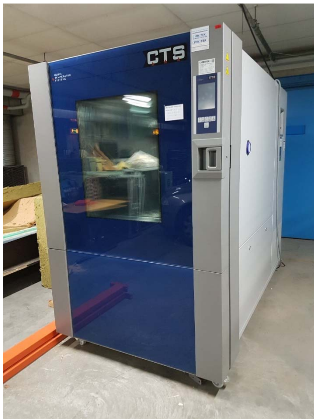
FIGUR 4. Klimakammer anvendt til accelereret ældning.
