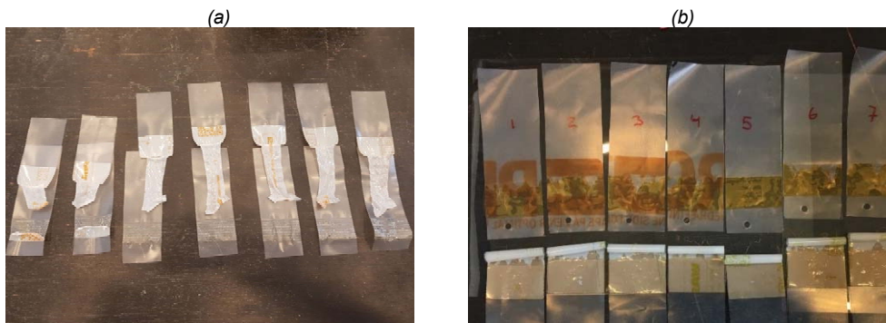
FIGUR 53. Afrivningsforskel for PE-membransystem T7482-2 med tapet samling før (a) og efter (b) accelereret ældning.
