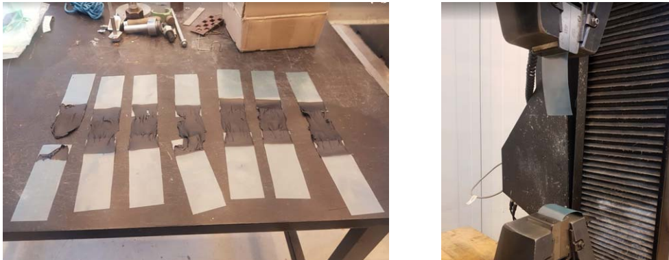
FIGUR 54. Afrivningsform for PE-membran samlet med bånd af butyl.
