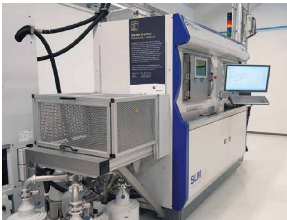
En af de store metal-3D-printere på Teknologisk Institut i Aarhus. (Foto: Mia Dahl).
