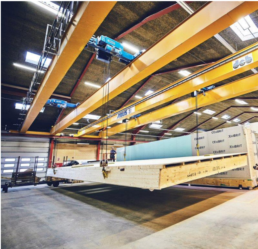
Figur 36. Produktion af tagelement i træ foregår indendørs i en produktionshal. Foto: Scandibyg.
