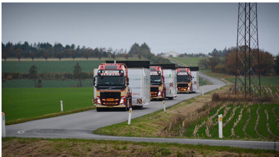
Figur 39. Rummoduler transporteres til byggepladsen på lastvogne på vejnettet. Foto Scandibyg.
