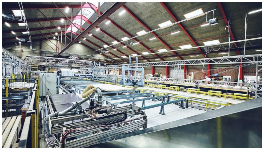
Figur 37. Produktionslinje for præfabrikerede elementer og moduler af træ til byggeriet. Foto: Scandibyg.
