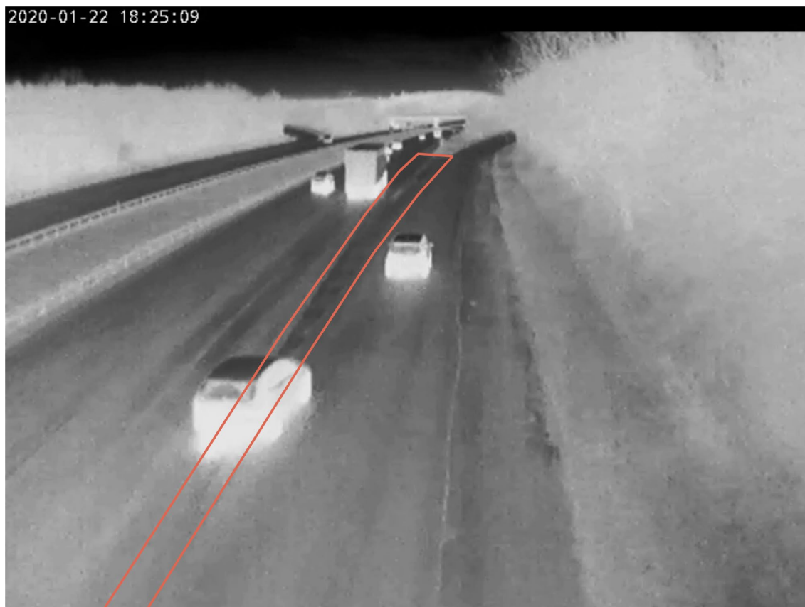
Figur 16 | Eksempel på sen frakørsel ved lokaliteten i Kolding. Hændelsen fandt sted i mørke og efter slukningen af portalbelysningen. Personbilen krydser hen over den første del af spærrefladen fra første vognbane. Klik her for video af situationen.
