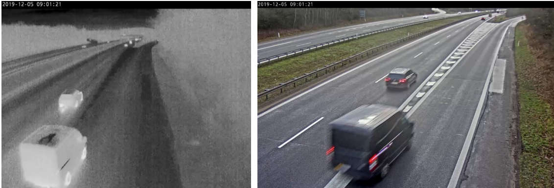
Figur 13 | Er det en minibus eller en varebil? Køretøjstypen kan være vanskelig at vurdere ud fra de termiske videoer (t.v.), mens det fremgår tydeligere af videoerne fra det almindelige videokamera (t.h.).
