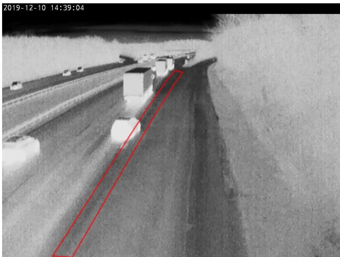
Figur 11 | Analyse i videoanalyseprogrammet RUBA til registrering af situationer, hvor der køres over spærrefladen.
