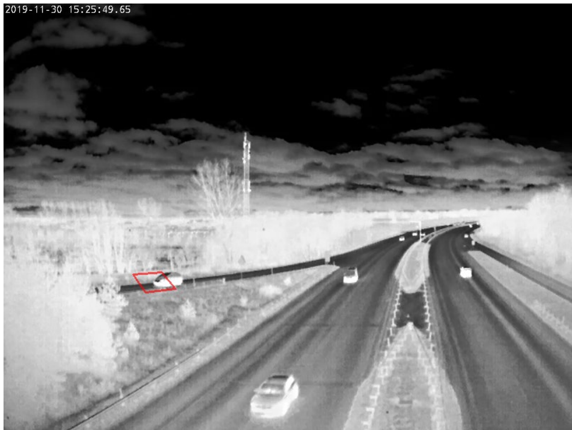
Figur 15 | Analyse i videoanalyseprogrammet RUBA til tælling af trafikanter på frakørslen.
