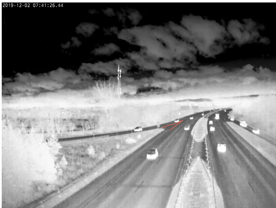
Figur 8 | Videobillede fra frakørsel 26 ved Aalborg. Spærrefladens udstrækning er markeret med rødt.
