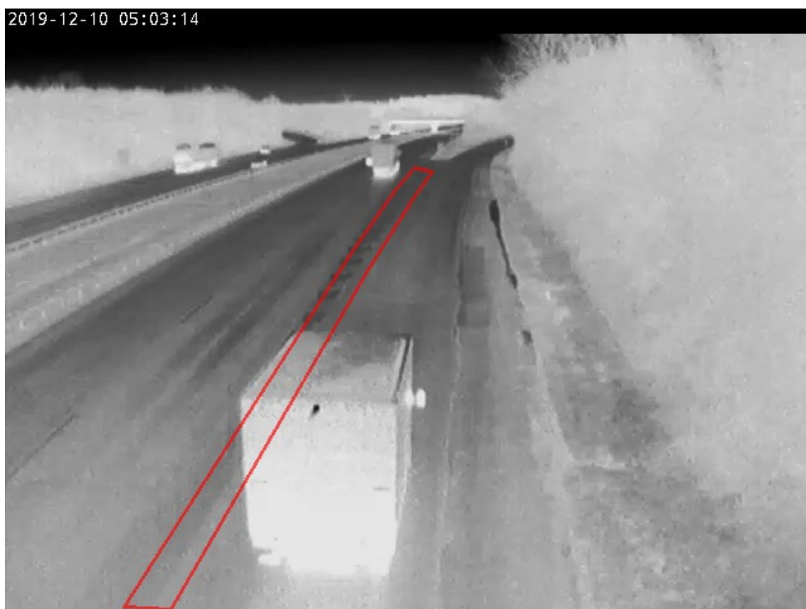
Figur 12 | Eksempel på registrering af falske positive i RUBA. Lastbilens tag skærer pga. højden ind over feltet og bliver derfor registreret som en potentiel overkørsel af spærrefladen.
