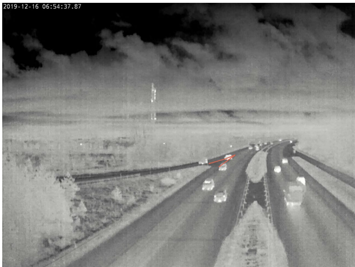
Figur 18 | Eksempel på sen frakørsel ved frakørslen i Aalborg. Hændelsen fandt sted i mørke og før slukningen af portalbelysningen. Personbilen kører i anden vognbane og drejer pludseligt mod højre hen over første vognbane og spærrefladen for at køre fra motorvejen. Klik her for video af situationen.
