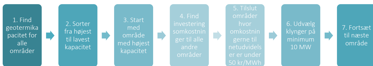
Figur 24: Metode for 10 MW geotermiklynger
