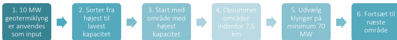
Figur 25: Metode til 70 MW geotermiklynger
