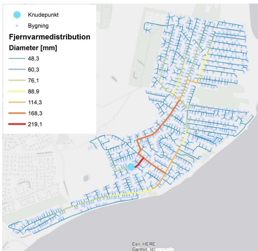
Figur 11: Eksempel på output fra distributionsmodellen for 3GDH uden varmebesparelser
