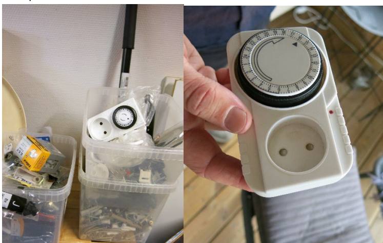
Billede 21-22 To eksempler på el timere med analogt ur (NJ3 og MJ2)
