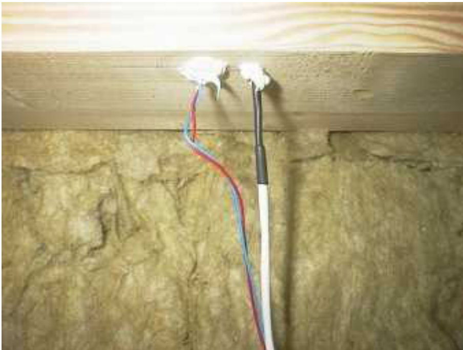
Figur 12. Fugt- og temperaturfølere var placeret i konstrukstræet i en afstand på ca. 10 mm fra kanten.
