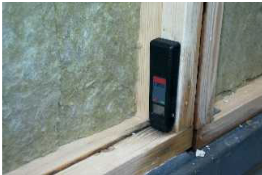
Figur 14. Eksempel på bestemmelse af fugtindhold med elektrisk træfugtighedsmåler i et elementhjørne.
