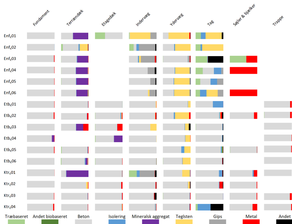
Figur 1. Materialer anvendt i bygningsdelene for de forskellige casestudier ved konventionel byggeskik. Fordelt baseret på vægt. Enf=enfamiliehus. Etb=etagebolig, Ktr=kontor, τ=træbaseret byggeskik.
