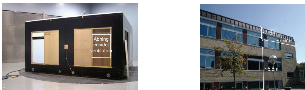
Figur 2. Forsøgsbygningen i vindtunnellen (5,6x5,6x3m) (til venstre) og kontorbygningen brugt til udendørs forsøg (til højre).
