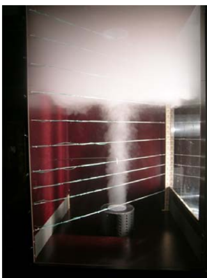
Figur 24 Modelforsøg med lagdeling af røg.
