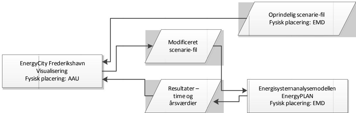
EFV henter denne scenariefil ved opstart, og det er med udgangspunkt i denne, at brugere derefter kan modellere visse ændringer i energisystemet.
