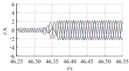
图9 接口换流器交流侧电流波形
