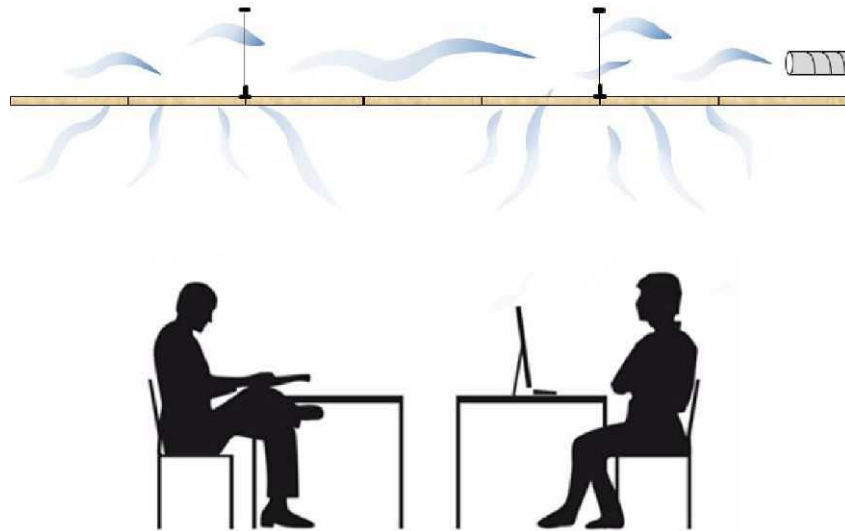
Abbildung 2: Anlage für die diffuse Deckenlüftung
