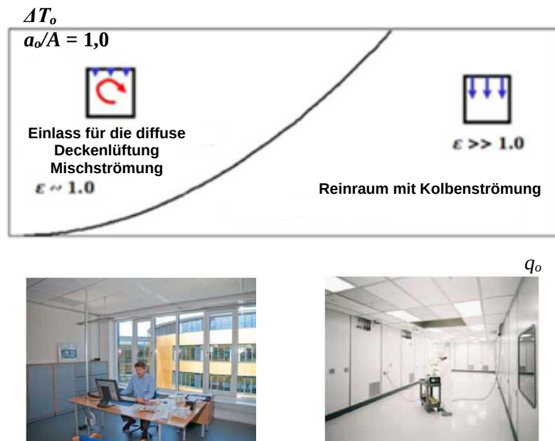
Abbildung 4: q - \Delta T -Diagramm der diffusen Deckenlüftung, zwei Anwendungsbeispiele: Büro und Reinraum [9]
