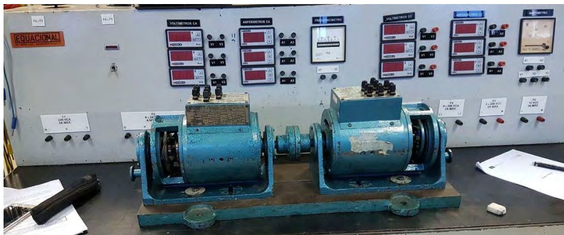
Figura 38. Bancada do laboratório com duas máquinas de corrente contínua acopladas.
