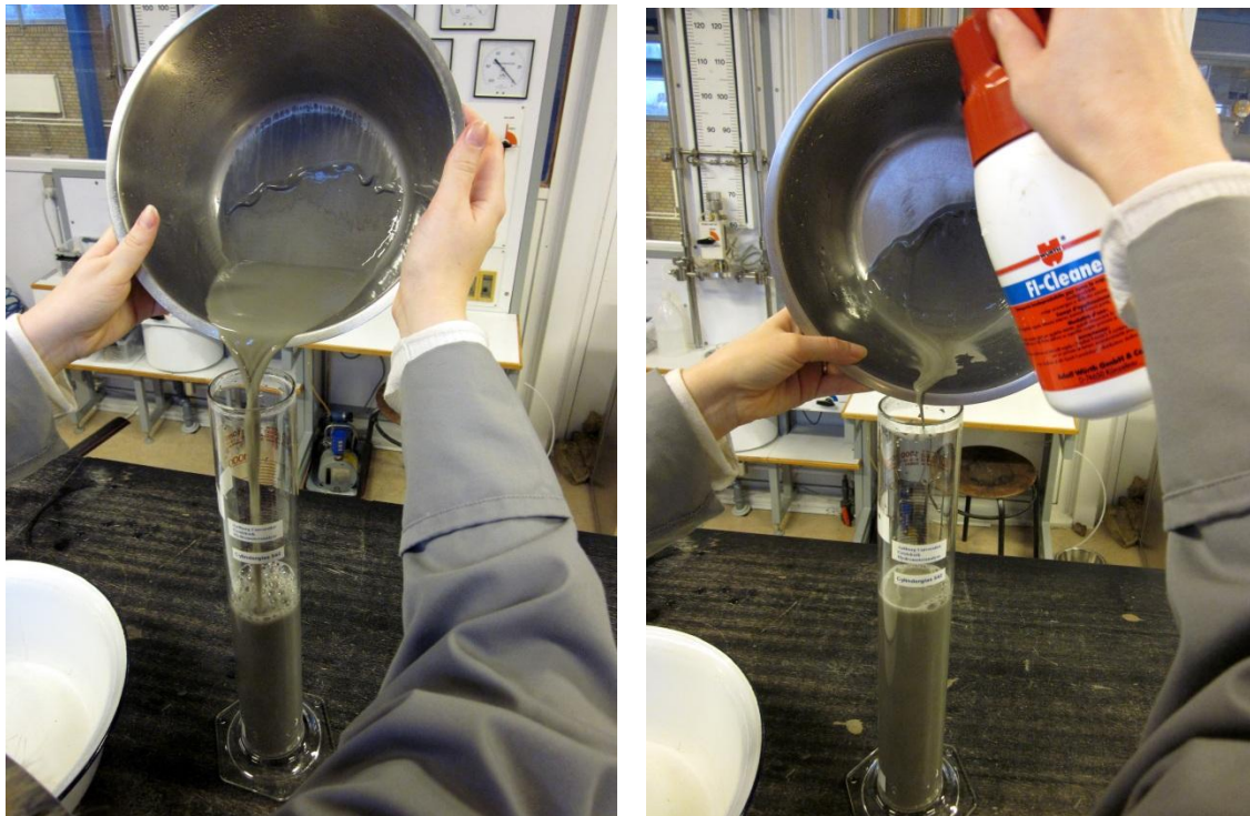
Figur 4: Opslæmningen hældes på cylinderglass, tryksprayeren kan bruges til at få det sidste af opslæmningen i cylinderglasset.
