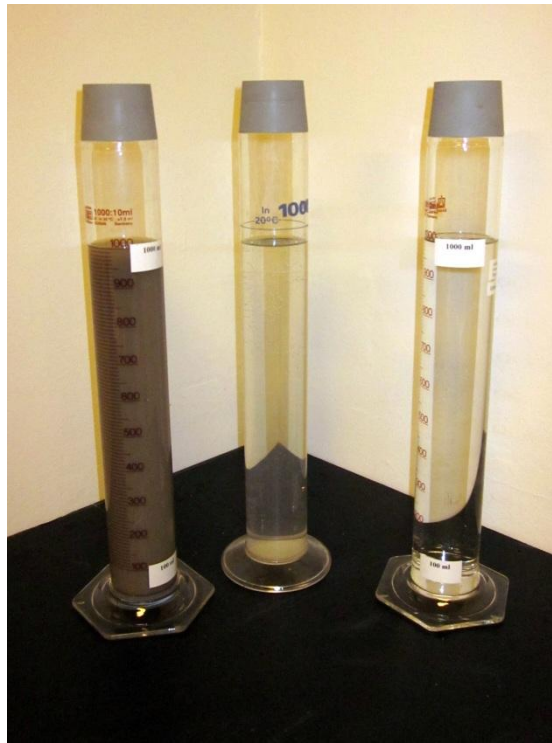
Figur 5: Cylinderglas i klimarum. Hver cylinders åbning er dækket af en prop. Cylinderne er fyldt med (fra venstre): Opslæmning, demineraliseret vand og referencevæske.
