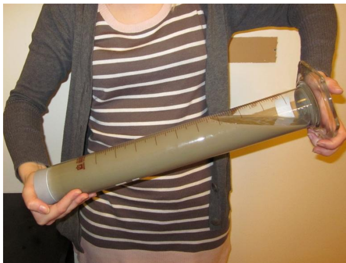
Figur 6: Cylinderglasset med opslæmningen rystes inden forsøget påbegyndes.
