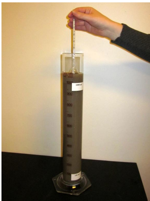
Figur 7: Hydrometret sænkes forsigtigt ned i opslæmningen til flydedybde.
