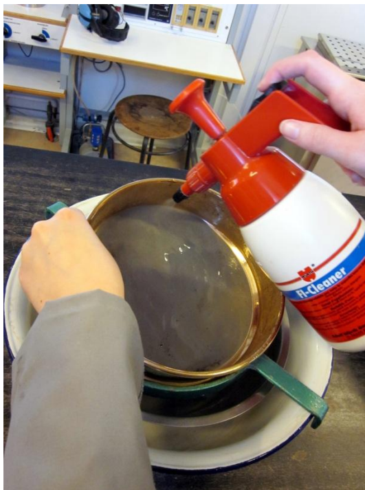
Figur 3: Udvaskning af silt på en 0,063 mm sigte.
