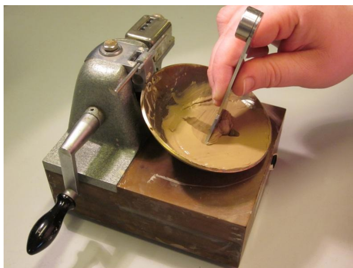
Figur 9: Furen laves over flere omgange, hvor furejernet hele tiden holdes vinkelret på skålen.
