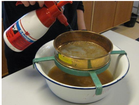
Figur 7: Udvanding af silt.
