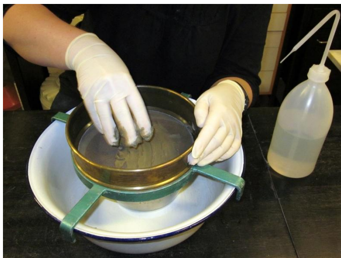
Figur 5: Materialet masseres forsigtigt igennem en 0,42 mm sigte.
