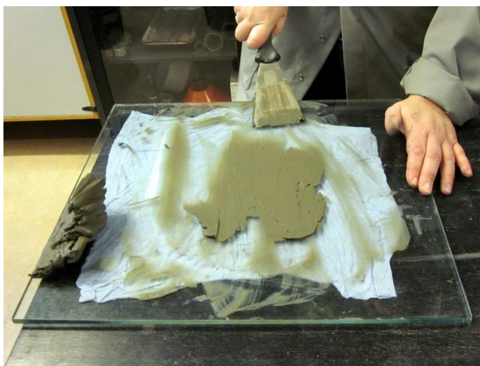
Figur 6: Materialet spartles i små portioner på en glasplade. Placer eventuelt en fugtig klud under glaspladen for at fastholde den.
