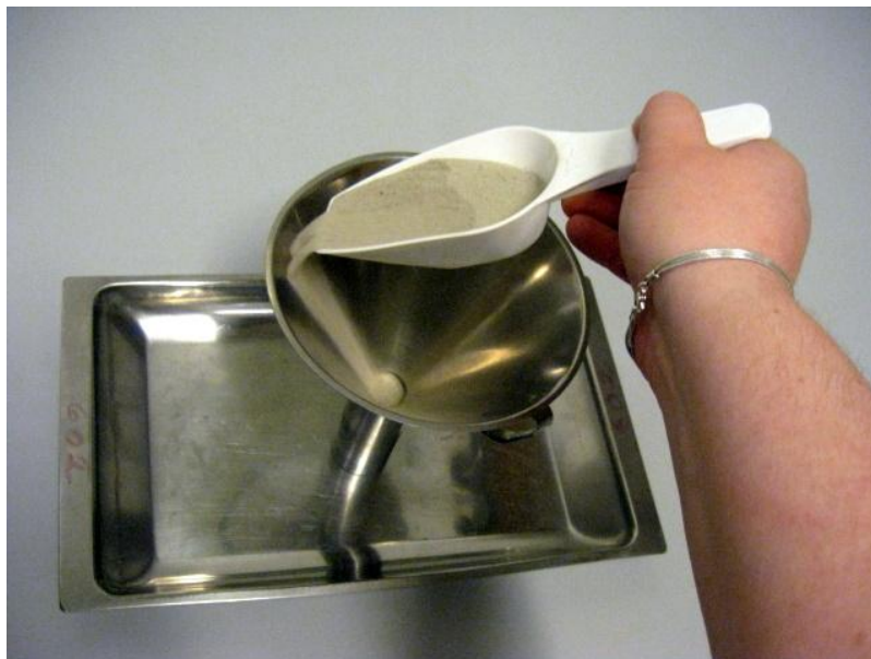
Figur 2: Materiale fyldes i lille cylinder ved at lade det glide forsigtigt ned langs kanten af tragten.
