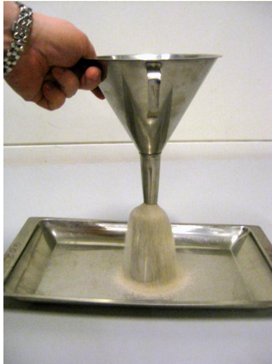
Figur 3: Lille cylinder fyldt med materiale, og overskydende materiale løber over.
