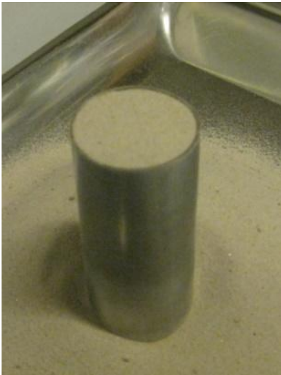
Figur 5: Afrettet cylinder, hhv. før og efter der er slået hårdt i bordet.
