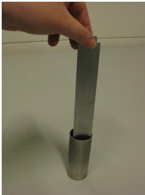
Figur 6: Afretning af overfladen af materialet med en stållineal.
