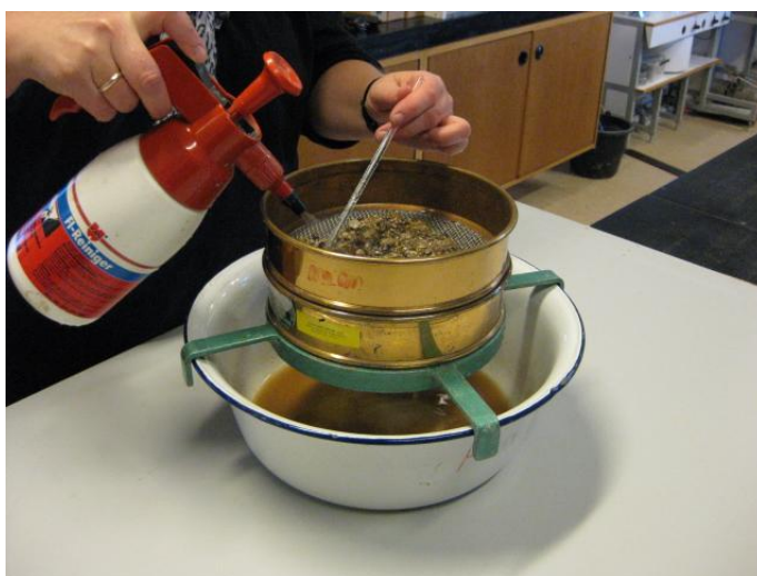
Figur 4: Udvaskning på 2 mm og 0,063 mm sigter.
