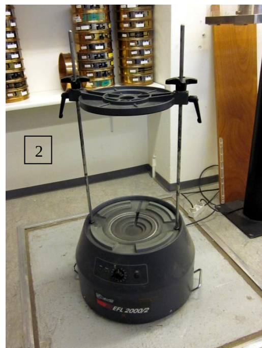
Figur 1: Sigter benyttet til grov- og finsigtning samt rystemaskine.
