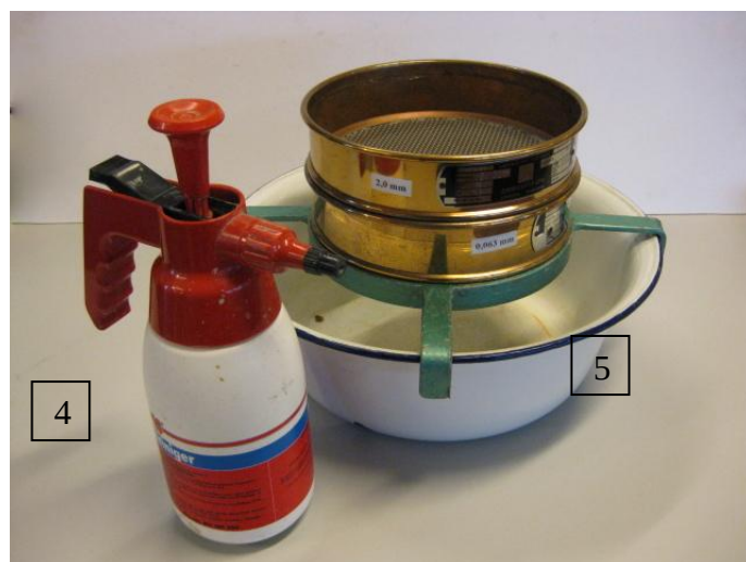
Figur 2: Apparatur til udvaskning.
