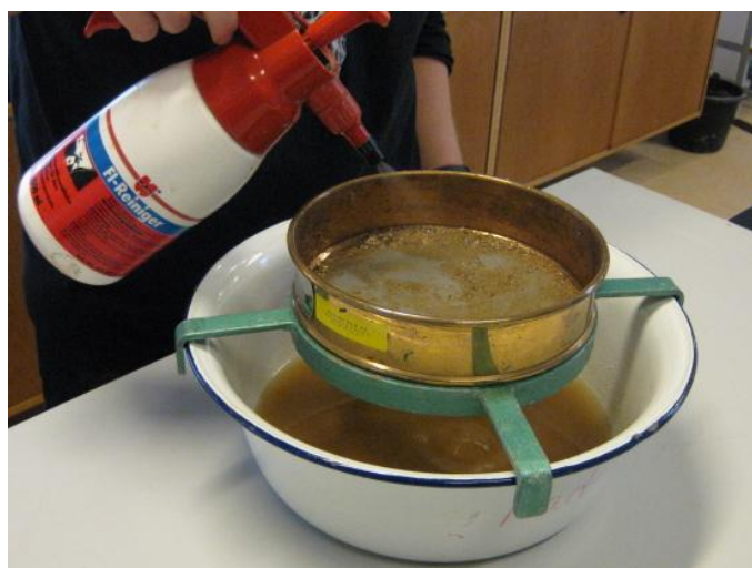
Figur 5: Udvaskning på 0,063 mm sigte.
