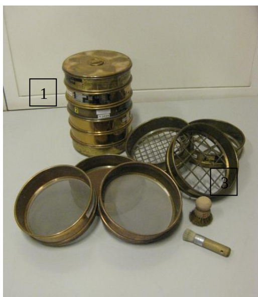
Figur 1: Sigter benyttet til grov- og finsigtning samt rystemaskine.
