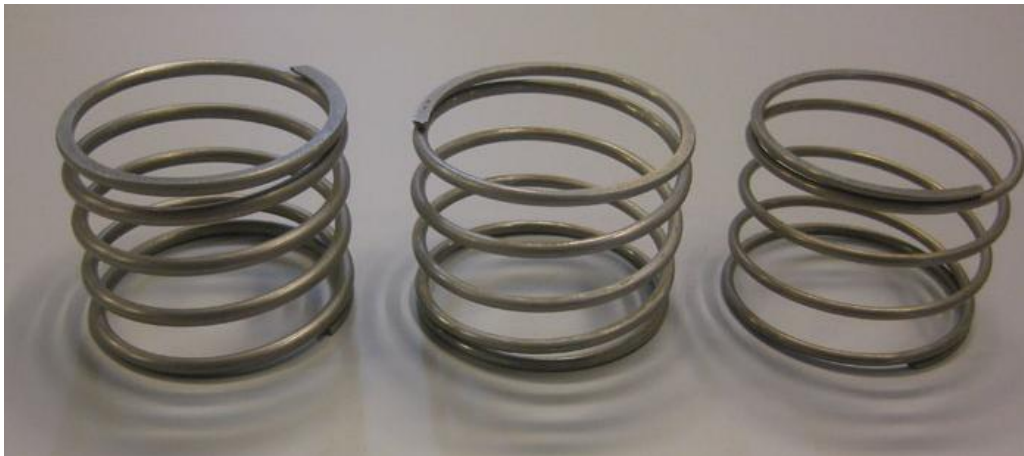
Figur 0.10: De tre forskellige fjedre; blød mellem og hård.
