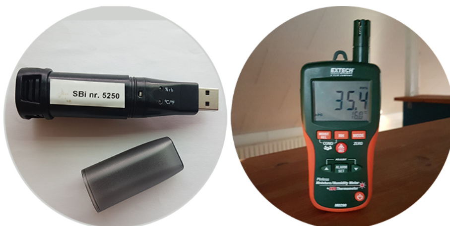
Figur 6. De batteridrevne dataloggere og hygrometeret til måling af temperatur og relativ luftfugtighed.
