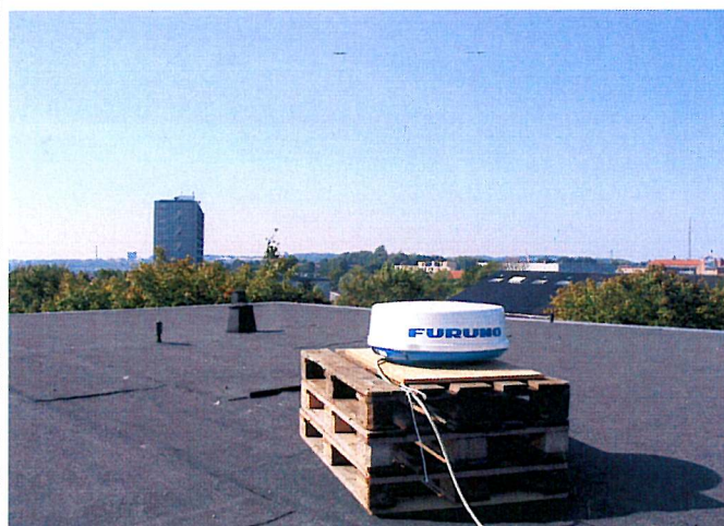
Aalborg Mobil vejrradar placeret på taget af Aalborg Universitet. Bemærk patenteret palleopstilling!
