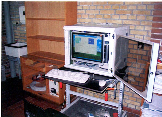
Processor enhed til den mobile vejrradar.
