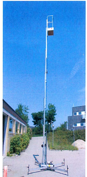
Mobil sojlelift til montering af Mobil Vejrradar
