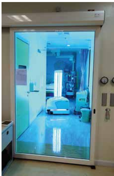
Med ultraviolet lys kan de danske robotter dræbe virus og bakterier.
