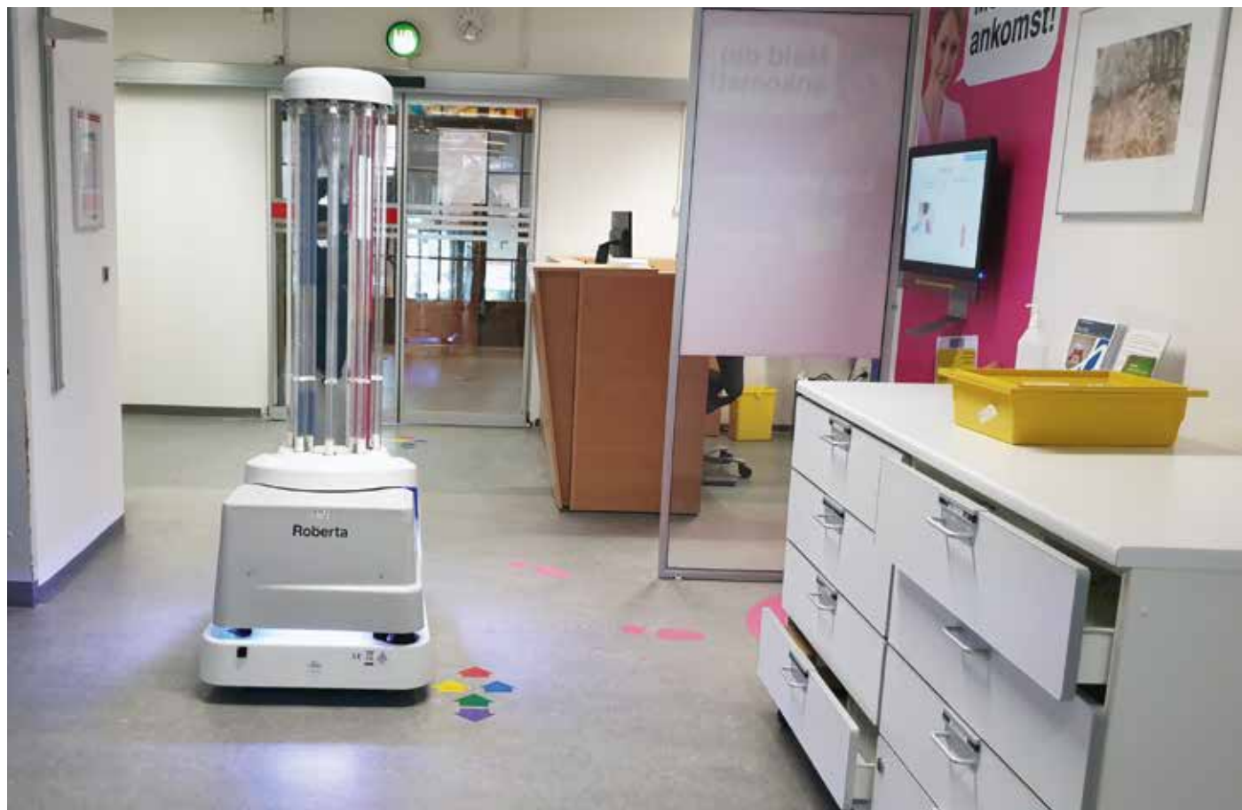
Robotten kører selv hen til den angivne stue, og undervejs åbner den elektriske døre ved hjælp af wi-fi. (Foto: Esben Hansen).
