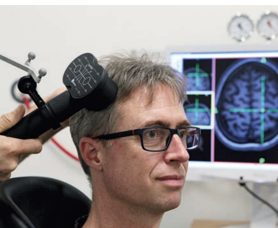
Axel Thielscher, seniorforsker på DRCMR og DTU Sundhedsteknologi, deltager her i et såkaldt TMS-eksperiment (Transcranial Magnetic Stimulation) med en magnetisk transducer på hovedet. I baggrunden vises hjernens anatomi, så man kan ramme det korrekte område. Et af målene med projektet er at forbedre denne visualisering.
