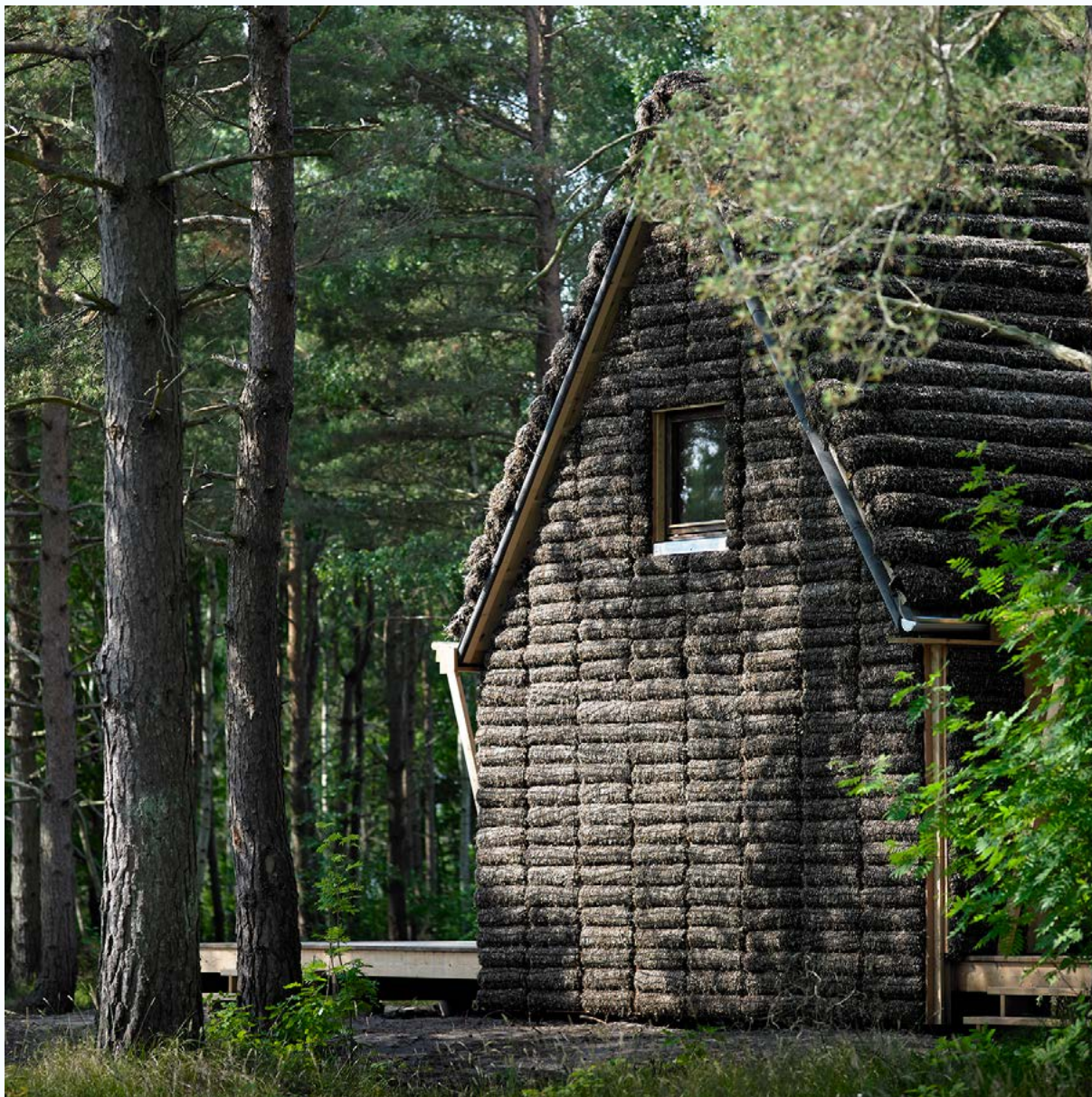
På Læsø er det traditionen at bruge tang som byggemateriale. I Det Moderne Tanghus er der eksperimenteret med, hvordan ålegræs kan bruges som byggemateriale i nutidigt boligbyggeri (Arkitekter: Tegnestuen Vandkunsten).
