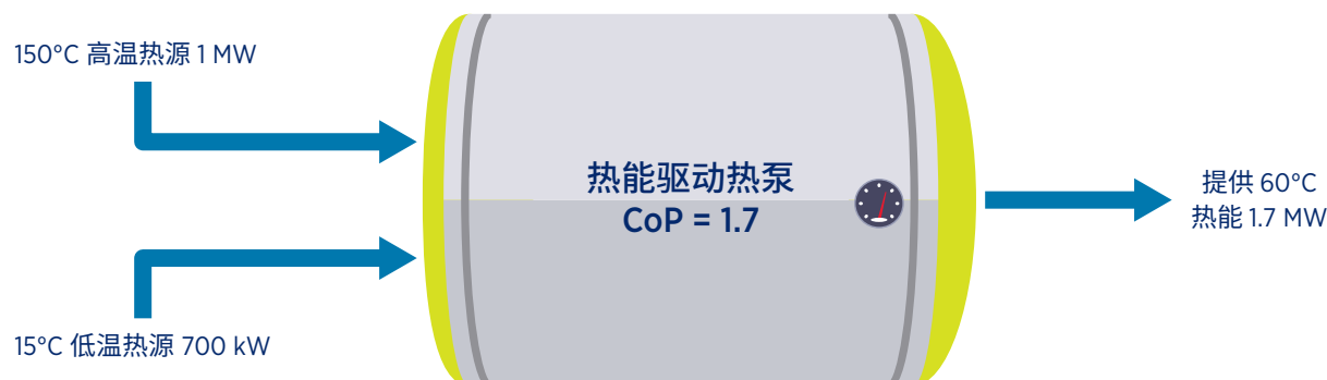
图 16：吸收式热泵的工作原理
