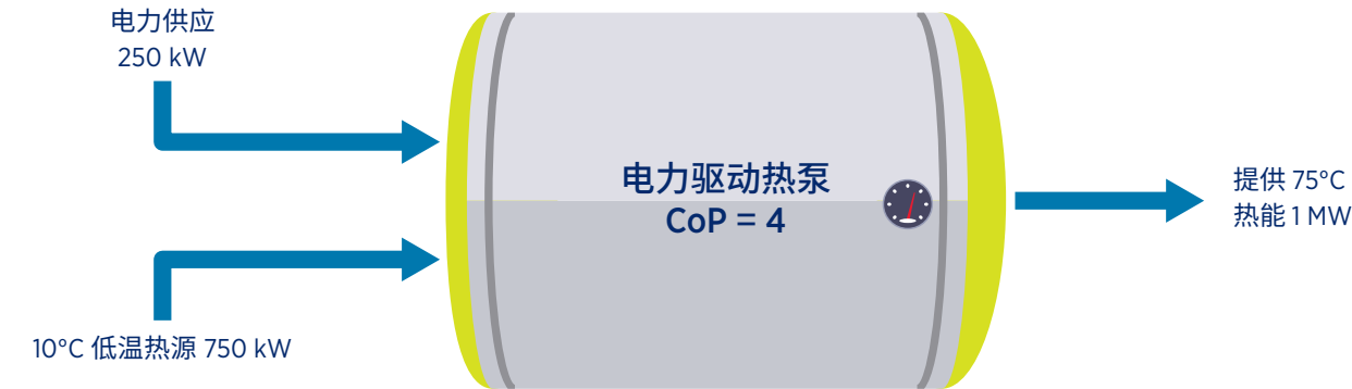
图 15：压缩式热泵的工作原理
