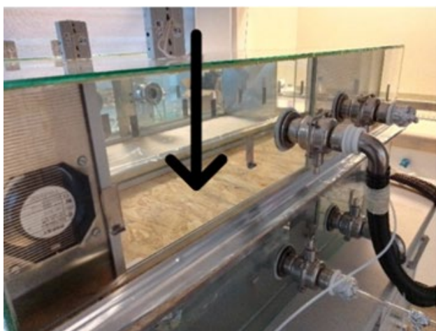
FIGUR 9. Dobbeltkammer bestående af to CLIMPAQ kamre med luftindtag og -udtag adskilt af en OSB-plade (tv). Blue Cap flasker med ethanol (VOC-kilder) i det nederste kammer (th). (Foto: Helle V. Andersen).
