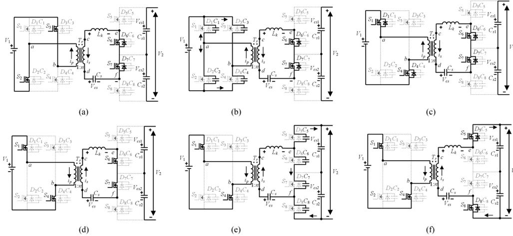
**FIGURE 4.** Equivalent operating circuits. (a)  $[t_0 - t_1]$ . (b)  $[t_1 - t_2]$ . (c)  $[t_2 - t_3]$ . (d)  $[t_3 - t_4]$ . (e)  $[t_4 - t_5]$ . (f)  $[t_5 - t_6]$ .
