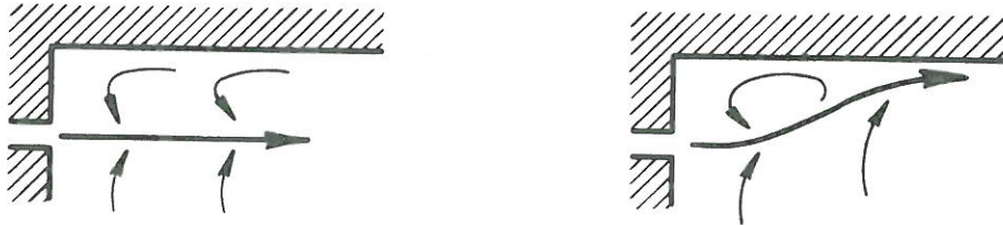
Fig. 2.4-1. Strømningsforhold omkring en plan stråle tæt ved en flade.
