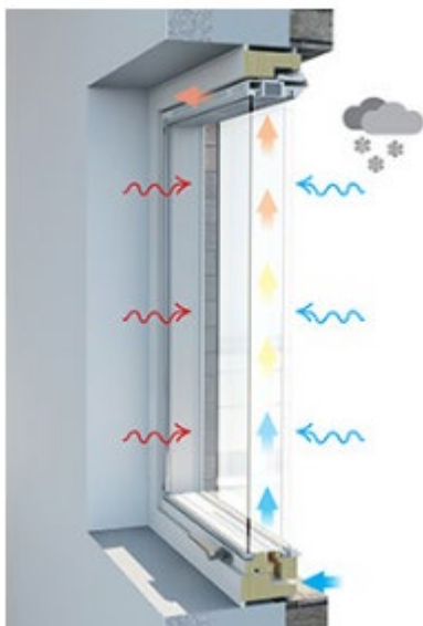
Figur 7. Eksempel på indtag via vindue med forvarmning. Illustration fra LivingBetter.
