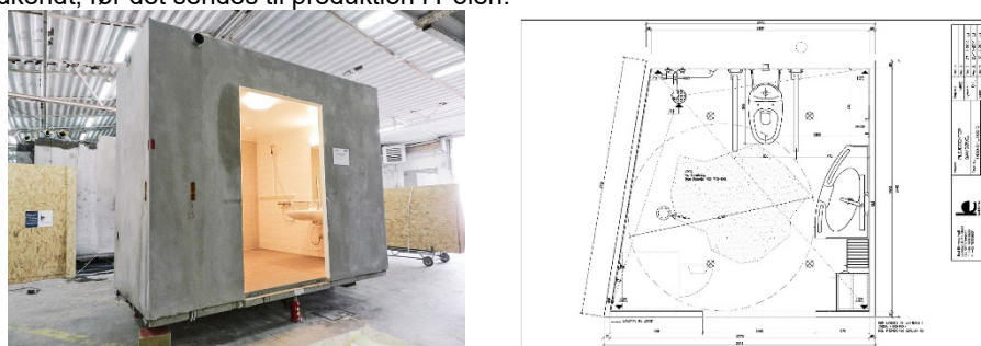
Figur 2. Badelement fotografi og tegningseksempel på det præfabrikerede systemprodukt. Foto og tegning fra Badelements danske hjemmeside.
