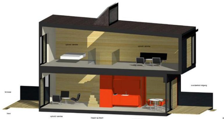
Figur: Basisbolig på 85 m 2 fordelt på to etager – og leveret i form af to rumstore moduler.
