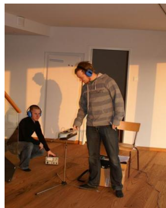
Figur D.3. Måling af efterklangstid i Komforthusene.
