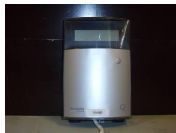
Figur B.0.4: HGQ1 måler til varmekonsum.
