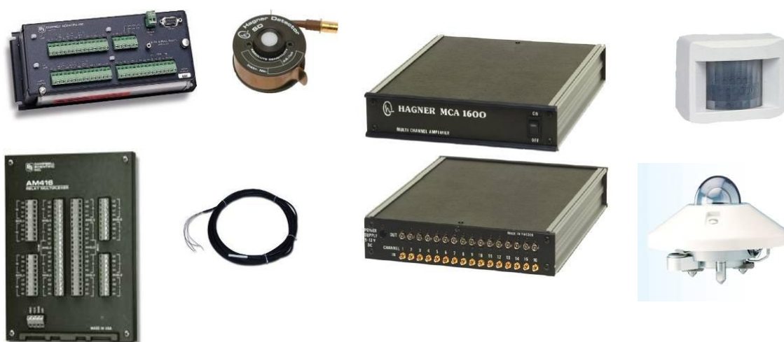
Figur 39. Foto af hoveddelene i måleudstyret. 1) Campbell Scientific data logger model CR10X udstyret med en model AM416 multiplexer for 32 analoge kanaler, 2) Måling af belysningsstyrke (15 Hagner sensorer, model SD2 via Hagner MCA1600 amplifier; 3) Indendørs/udendørs temperaturmåling ved to Campbell Scientific BetaTherm 100K6A1 Thermistor sensorer; 4) To PIR-sensorer; 5) Pyranometer, model Kipp&Zonen CM5.
