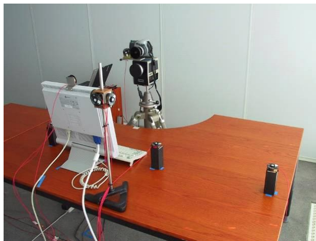
Figur 61. Måleopstilling i målerum med CCD kamera placeret svarende til forsøgspersonens øjenplacering i forsøgsrummet. Persiennejusteringer og ændringer på pc-skærmen følger slavisk ændringer i rummet, hvor forsøgspersonen er placeret.
