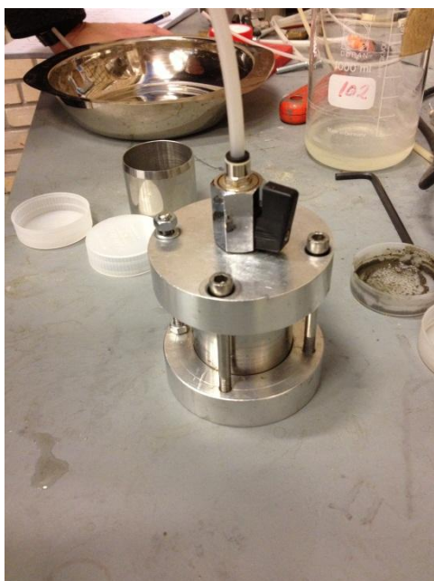
Figur 6: Gevindstænger skrues fast.
