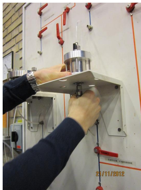
Figur 7: Prøve fastgøres i apparat (ventiltavle).
