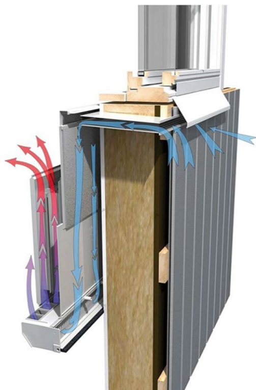
Figur 6. Friskluftindtag i ydermur i Sallinghus, hvor den kolde luft forvarmes, før den distribueres rundt i lejligheden. Billedet er gengivet med tilladelse fra Purmo Group Denmark ApS.
